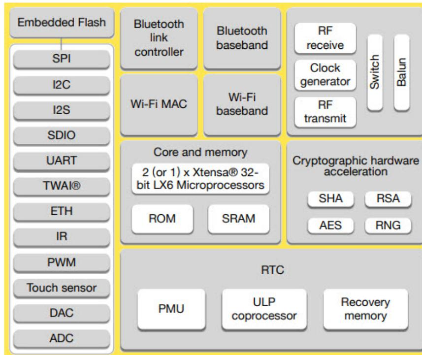
FIGURE 4.7: ESP32-Block-Diagram [40].
