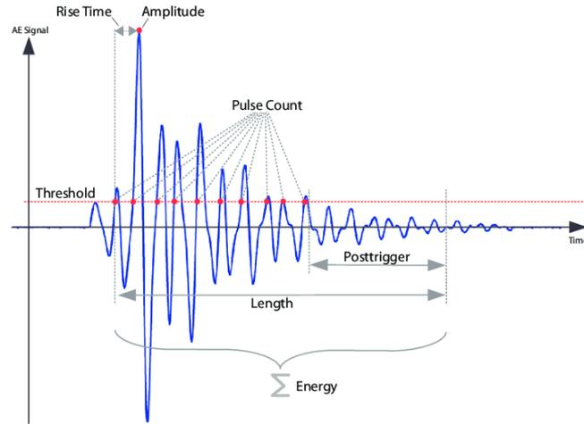
FIGURE 2.1: AE impulse parameters [13].
